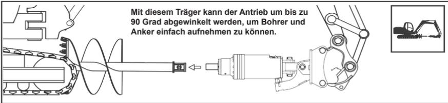
Keine Pfahlinstallation bei ganz nach oben geklappter Kupplung.
