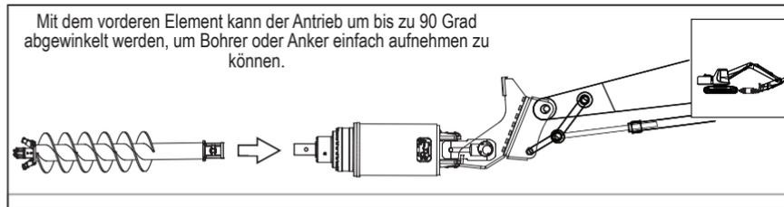
Vermeiden Sie das Einbringen eines Pfahls, wenn das Befestigungselement vollständig eingefahren ist.
